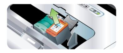
2. 乾いた綿棒で、プリントカートリッジ収納部の電気接点部を クリーニングします。
