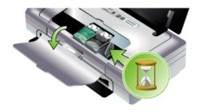
3. プリント カートリッジのラッチを持ち上げて開き、収納部か らプリントカートリッジを静かに取り外します。
