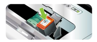
5. プリントカートリッジのラッチを閉じます。カートリッジが正しく挿入されている場合は、ラッチを閉じるとカートリッジが収納部に引き込まれます。ラッチを押してみて、ラッチが平らになっていることを確認します。
