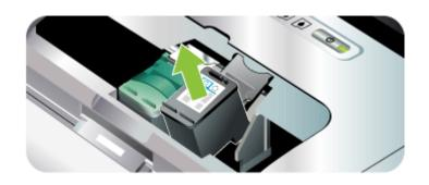
4. 取り外した古いプリント カートリッジと同じ角度で、新しい プリント カートリッジを収納部に挿入します。ラッチとプリ ント カートリッジの記号を照合して、正しいプリント カート リッジを挿入していることを確認します。
