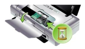
**2.** プリント カートリッジのラッチを持ち上げて開き、収納部からプリント カートリッジを静かに取り外します。
