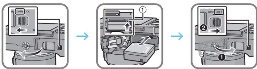
● 向きに気をつけて、ロック音がするまで確実に奥まで挿入し、バッテリーに①のレバーがかかっていることを確認してください。取り出すときは、①のレバーを矢印の方向に引いて取り出してください。
