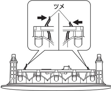
6. ソケットから交換する電球を引き抜きます。
