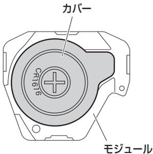
4. 矢印の方向に軽く押し込んで電池を取り出し、新しい電池と交換します。
