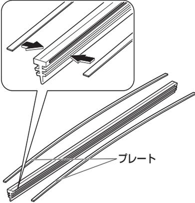
4. ブレードの中央のツメからラバーを挿入します。
