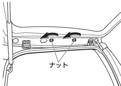
3. 矢印の方向にツメを押し、ランプ本体をバック ドアから浮かせます。
