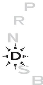
エンジン スイッチが“ON”の位置で、CVTシステムに異常があるとCVTシフトインジケータの“D”の位置が点滅します。
