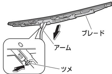
3. ブレードのロックが外れていることを確認し、アームからブレードを抜きます。
