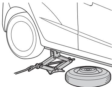
7. 4 個のホイール ナットを外し、タイヤを外します。
