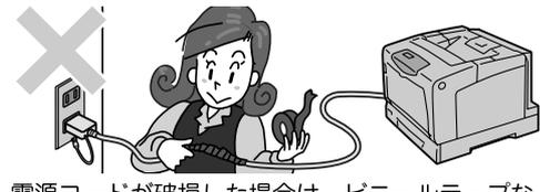
電源コードが破損した場合は、ビニールテープなどで補修して使用しないでください。補修した部分が過熱し、火災や感電の原因となるおそれがあります。損傷したときは、すぐに同じ電源コードに取り替えてください。
