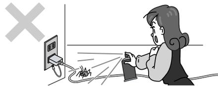
電源コードに殺虫剤などの薬品類をかけないでください。コードの被覆が劣化し、感電や火災の原因となることがあります。
