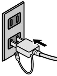
万一、漏電した場合の感電や火災事故を防ぐために、アース線を必ず次のいずれかに取り付けてください。
