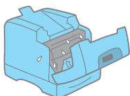
操作パネルを使用して、スリープモードに移行する時間を 1 時間以上に設定し、電源を入れたまま放置してください。機内があたためられ、約 1 時間で水滴がなくなり、正常に使用できます。
